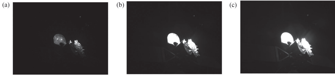
图12 传统帧相机拍摄不同积分时间拍摄。(a)1 000 \mu\text{s} ; (b)1 100 000 \mu\text{s} ; (c)1 250 000 \mu\text{s}
